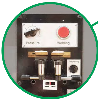
Knip-, las- en slijpinrichting t.b.v. lintzaagblad
